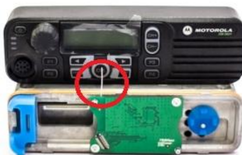
Рисунок 9 Установка опциональной платы ST001.M1
