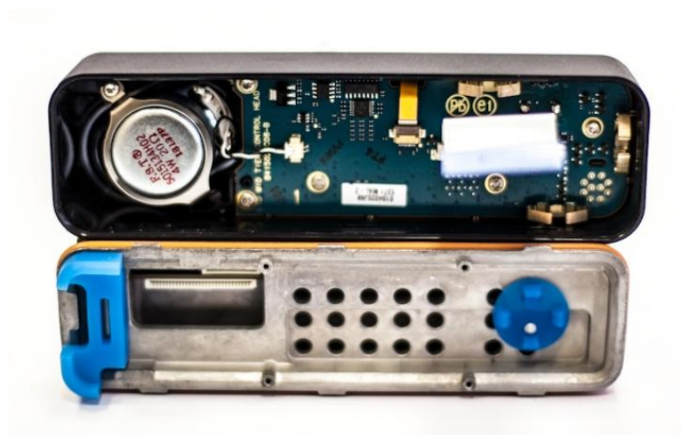
Рисунок 7 Радиостанция. Вид без фронтальной панели
