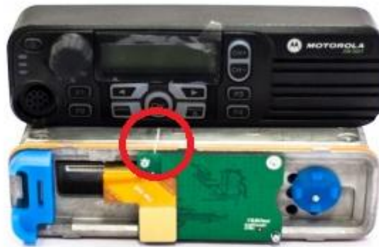
Рисунок 10 Положение шлейфа и опциональной платы ST001.M1
