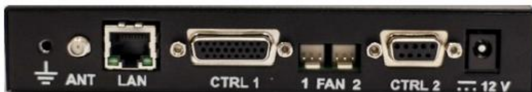
Рисунок 3 Задняя панель IP контроллера TRBOnet Swift Agent A002.M1.
