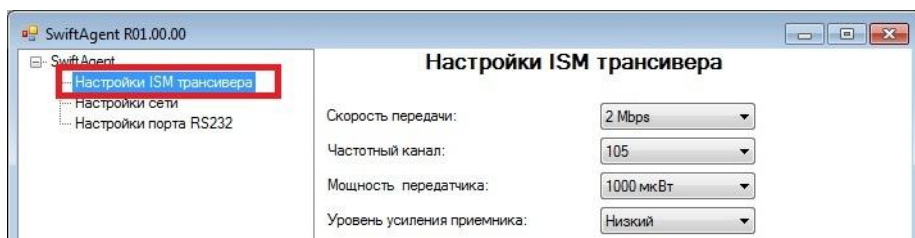
Рисунок 27 Настройки ISM трансивера
